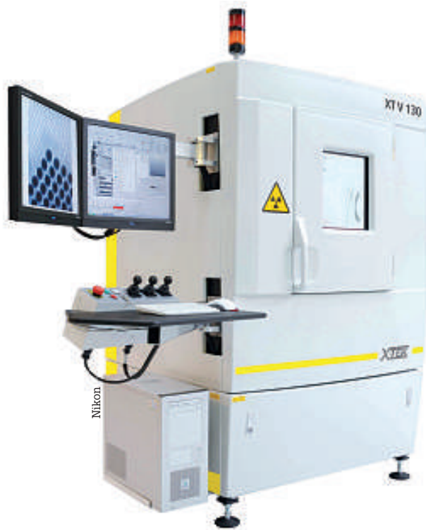
← Le distributeur Antycip propose des appareils Nikon et Saki. Le modèle Nikon XTV 130C de la photo repose sur un tube ouvert 130kV-10W et présente un grossissement géométrique maximal de 2400x et une résolution de 2µm.
