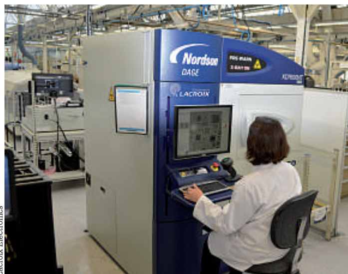
➔ Le XD7600NT Ruby FP de Nordson Dage, distribué par Metronelec, présente un grossissement géométrique de 2500x et une résolution de 0,5µm. Lacroix Electronics l'utilise, ainsi que des modèles Cheetah FP et Tigger de marque Yxlon.
